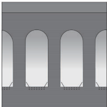
建物投光照明(建物埋込式) 高さ:0m～ 光源:LED、コンパクトFLほか
