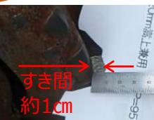
到達後、マシン先端に付いている刃がどのくらいすり減ったかを測定します
