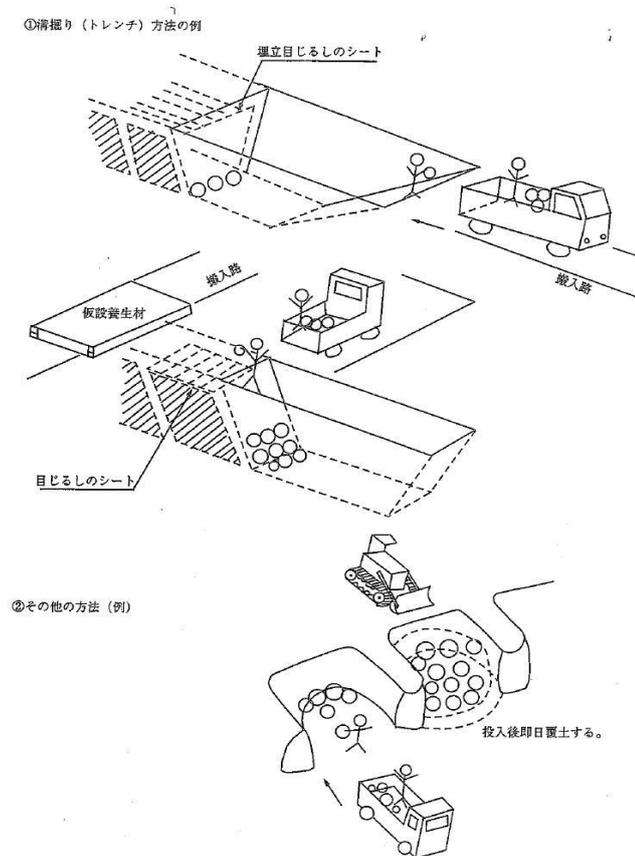
図 6-5 廃石綿等の埋立方法の例
