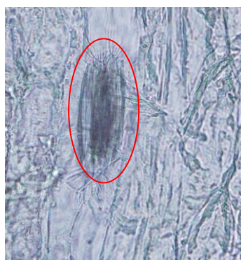
図6 1N塩酸添加前の位相差観察 (シュウ酸カルシウム確認)
